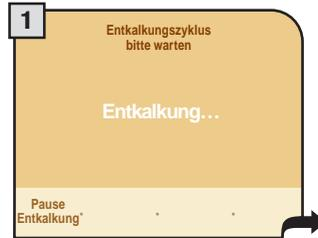
Die Maschine beginnt, das Entkalkungsmittel über die Heißwasserdüse auszugeben. Die Ausgabe erfolgt in voreingestellten Intervallen; auf diese Weise kann das Mittel gut wirken.
