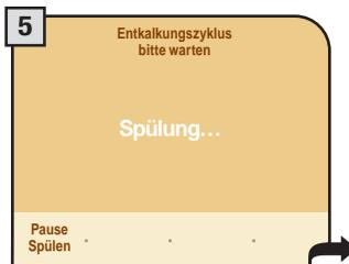
Die Maschine führt die Spülung durch. Nach der Spülung wird man zum Auffüllen des Tanks mit frischem Trinkwasser aufgefordert. Vor dem Zurücksetzen des Tanks kann gegebenenfalls wieder der Filter "Aqua Prima" eingesetzt werden.
