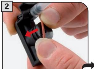
Den neuen O-Ring durch sanften Druck einsetzen.
