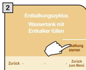
Wenn die Maschine gesperrt wird, erscheint auf dem Display die Meldung "Wassertank mit Entkalker füllen". Die Entkalkung wie beschrieben durch Drücken von "Entkalkung starten" durchführen.
