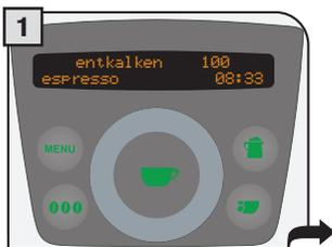
Die Maschine signalisiert mit einer blinkenden Meldung, dass eine Entkalkung erforderlich ist. Der Hinweis erfolgt nach 100 Ausgaben ab der letzten Entkalkung. Der Maschinenbetrieb wird durch den Warnhinweis nicht gesperrt. Der Zähler rechts neben dem Hinweis "Entkalken" wird nach jeder Produktausgabe vermindert. Wenn nur noch 30 Ausgaben bis zur Maschinensperre möglich sind, beginnt das Display zu blinken.
