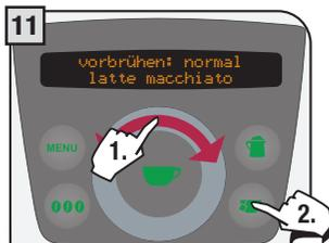
Das Vorbrühen (normal, stark, ausgeschaltet) durch Bewegen des Fingers über den Ring einstellen. Zum Speichern drücken.
