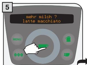
Sofern gewünscht, kann die Maschine anschließend eine zusätzliche Menge an Milch ausgeben. Diese Option bleibt ca. 3 Sekunden lang aktiv; zum Aktivieren die Taste
