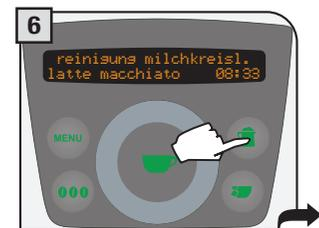
Die Maschine fordert zur Reinigung des Milchkreislaufs auf. Die Taste
