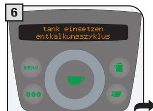
Den Wasserbehälter mit dem frischem Trinkwasser wieder einsetzen.
