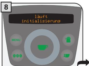
8 Die Maschine führt die Initialisierung des Filters durch.
