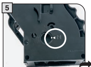
5 Assicurarsi che il gruppo sia in posizione di riposo; i due riferimenti devono coincidere.
