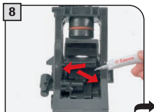
8 Solo con il grasso fornito in dotazione, lubrificare le guide del gruppo.
