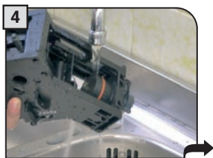
4 Lavare il filtro superiore con acqua corrente.
