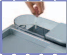
Streifen 1 Sekunde in das Wasser eintauchen. Kontrollieren, wie viele Quadrate ihre Farbe wechseln.
