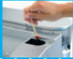
Mit der Bürste die Pulverkaffee-Dosiervorrichtung reinigen.
