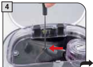
Die Schraube, die die Serviceabdeckung geschlossen hält, lösen.
