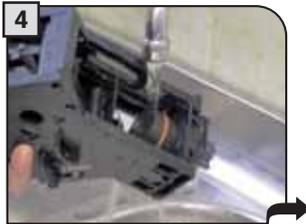
4 Den oberen Filter unter fließendem Wasser reinigen.
