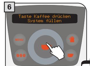
Drücken, um das System zu entlüften. Warten, bis die Maschine diesen Vorgang beendet.
