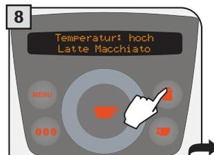
8 Die Taste für einen Zeitraum von mehr als 2 Sekunden drücken, um die anderen Parameter für die Programmierung zu öffnen.
