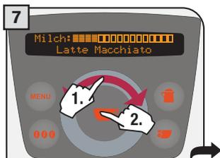
7 Die Milchmenge durch Bewegen des Fingers über den Anwahlring ändern und mit der Taste bestätigen.
