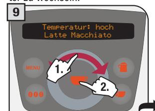
9 Die Temperatur (hoch, mittel, niedrig) durch Bewegen des Fingers auf dem Anwahlring einstellen. Für die Speicherung die Taste drücken.
