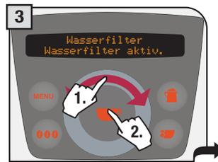
Über dieses Menü kann die Filterkontrolle ein- oder ausgeschaltet werden.
