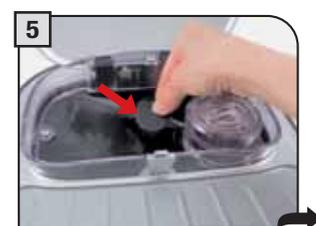
5 Die Schraube und die Abdeckung entfernen.
