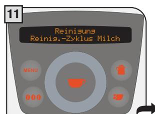
Nach Beendigung des Reinigungsvorgangs erscheint... Die Maschine setzt ein Tonsignal ab.
