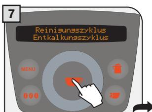
Den Maschinensystem spülen. Dazu die Taste
