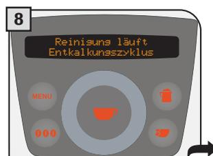
Die Maschine führt die Spülung durch. Während des Spülzyklus kann die Maschine dazu auffordern, den Wassertank zu füllen.
