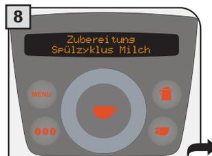
Der Benutzer kann nicht in diese Phase eingreifen und muss das Ende des Vorgangs abwarten. Die Maschine kehrt anschließend zum Hauptmenü zurück.
