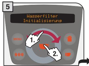
Über dieses Menü ist die Initialisierung eines neuen, soeben eingesetzten Filters möglich.
