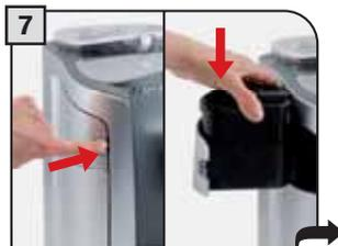
Die Milchschiublade öffnen und den Behälter mit dem Reinigungsmittel einsetzen.
