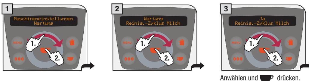
Nach Abschluss der Reinigungs- und Spülzyklen können Reinigungsmittel- und Wasserreste im Behälter bleiben. Vor einer erneuten Füllung des Behälters, in jedem Falle die darin enthaltene Restflüssigkeit entleeren.
