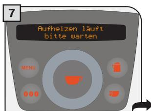
Nach Abschluss der Entlüftung warten, bis die Maschine die Aufheizphase beendet.
