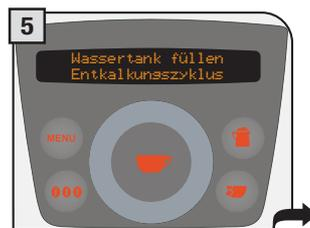
Den Wassertank herausnehmen und mit frischem Trinkwasser ausspülen, um die Entkalkungsmittelrückstände vollständig zu entfernen. Den Behälter anschließend mit frischem Trinkwasser füllen.
