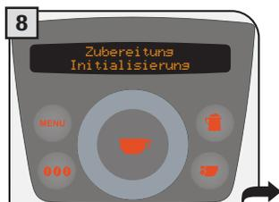
Die Maschine führt die Initialisierung des Filters durch.
