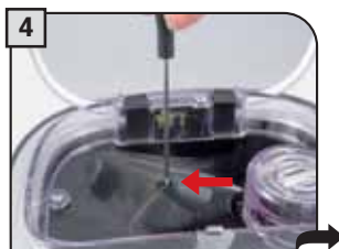
Die Öffnung des Mahlwerks mit einem Tuch abdecken. Die Schraube, die die Serviceabdeckung geschlossen hält, lösen.
