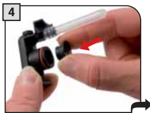
4 Den Verschluss vom unteren Teil abnehmen.
