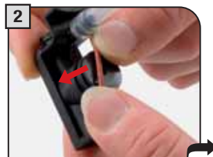
2 Den neuen O-Ring durch sanften Druck einsetzen.
