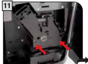
Beim Einsetzen die Taste PUSH nicht drücken!
