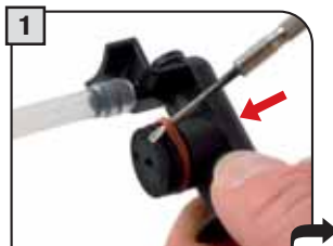
1 Den O-Ring unter Verwendung eines spitzen Gegenstandes entfernen.
